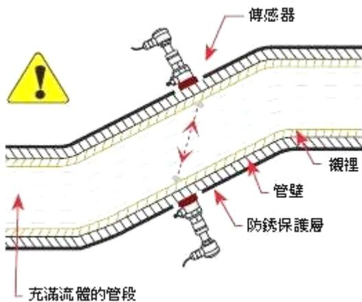
2. 安裝距離應選擇上游大於 10 倍直管徑、下游大於 5 倍直管徑以內無任何閘門、彎頭、變徑等均勻的直管段，安裝點應充分遠離閘門、泵、高壓電和變頻器等干擾源。
