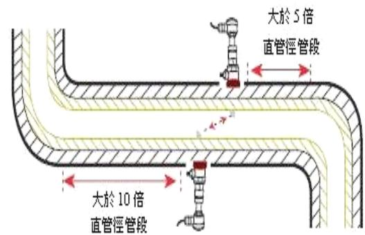
3. 避免安裝在管道系統的最高點或帶有自由出口的豎直管道上(流體向下流動)
