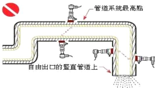
4. 對於開口或半滿管的管道，流量計應安裝在 U 型管段處。
