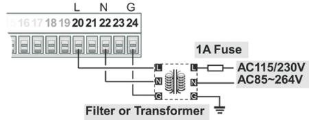
電壓 & 電流 輸入 (Terminal Block 1)
