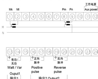
有功电能、无功电能、有功功率/电能组合、无功功率/电能组合—三相三线
