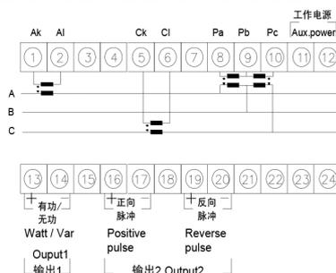
有功电能、无功电能、有功功率/电能组合、无功功率/电能组合—三相四线
